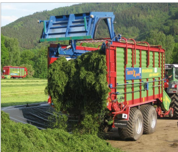
Der Trend bei den Ladewagen geht weg von den Dosierwalzen. Die Matrix-Ladewand ersetzt in diesem Fall die Heckklappe des Ladewagens.
