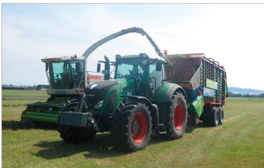
Von der Konzeptstudie zur Praxisreife: mit der MatrixCombi lassen sich Ladewagen auch von vorne befüllen. Das System hat S-A-S als Neuheit bei der Agritechnica angemeldet. Werkfotos
