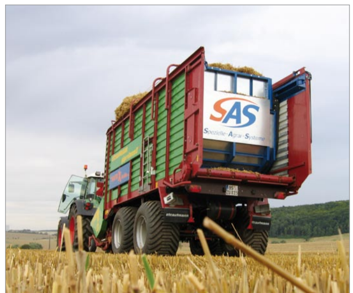
Großvolumiges Material wie Stroh wird mit der Ladewand verdichtet. Der Transportaufwand sinkt spürbar.
