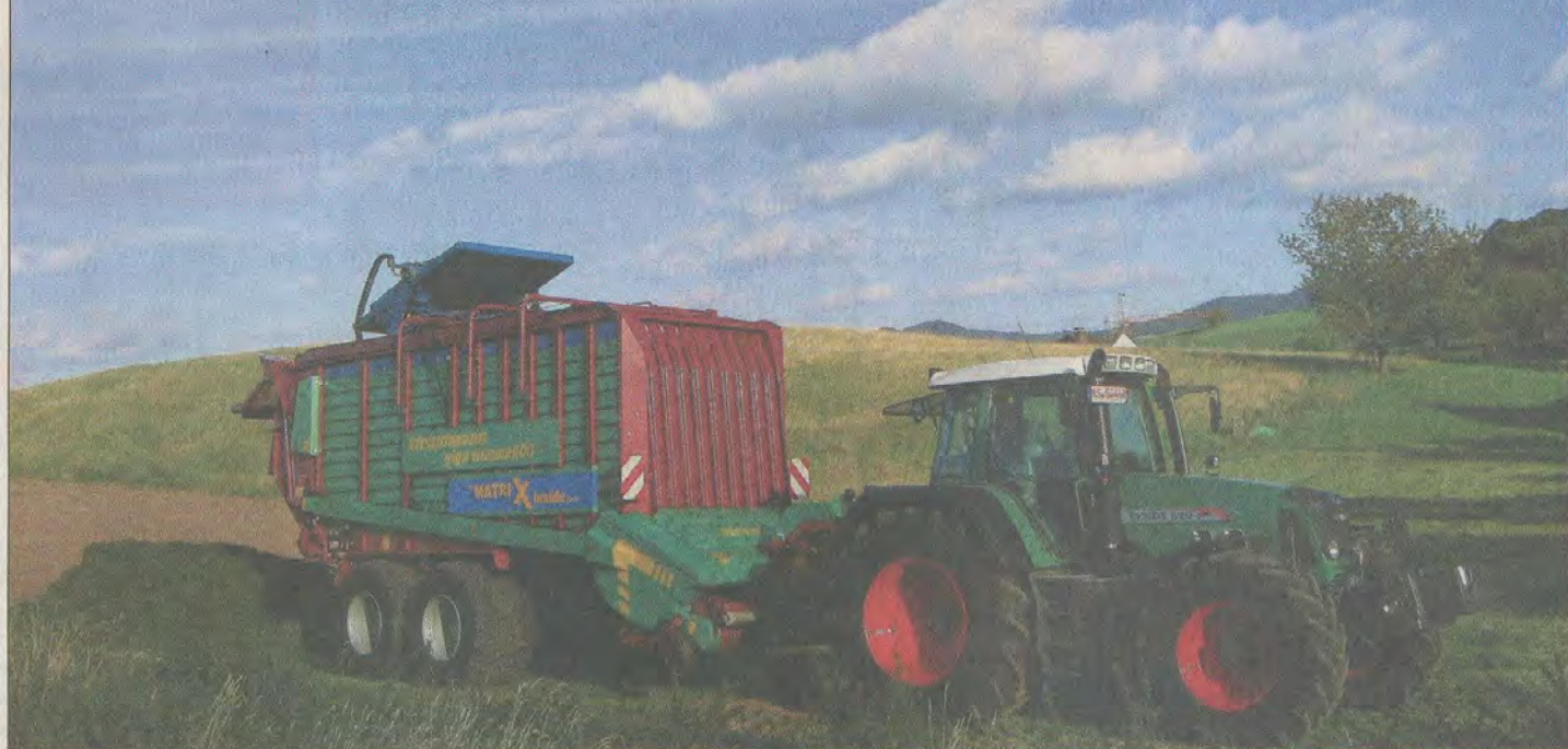
Die Ernte effizienter gestalten: Mit dem mobilen Ladesystem „MATRIXinside“ können Landwirte Zeit, Platz und Kosten sparen. Eine Trennwand verkleinert zunächst den Laderaum und wandert dann während des Ladevorgangs langsam nach hinten. Foto: Pflüger/nh
